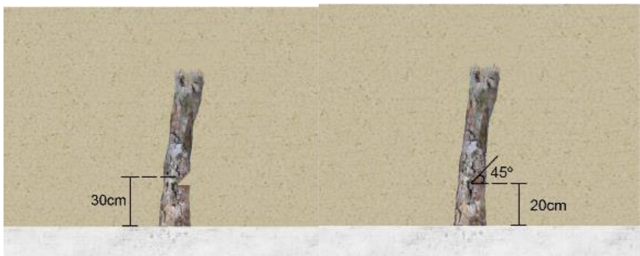
Figura 13: Abrir a boca com corte horizontal, Figura 14: Praticar o corte de abate horizontal depois diagonal.
