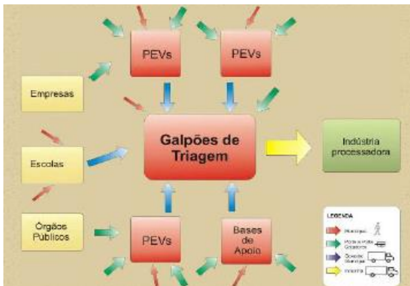
Figura 20: Fluxograma Ideal para o Sistema de Coleta Seletiva. (Fonte: MMA/MCID, 2008)
