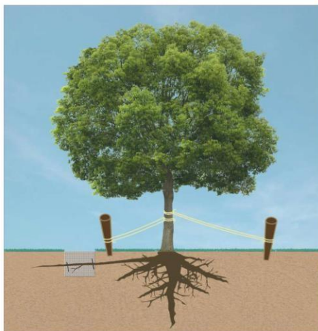
Figura 5 - Escoramento para evitar queda de árvore ao podar a raiz. Fonte: Architectus.
