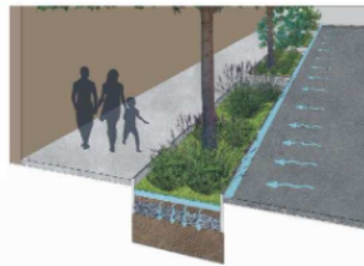
Figura 23 - Canteiro pluvial associado a calçada promove a retenção das águas pluviais e potencializa .
