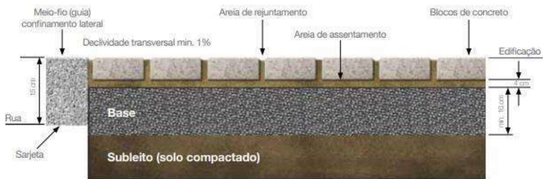
Figura - Componentes do Piso Intertravado
